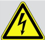
Ce marquage indique la présence de tension électrique ou de haute tension.
