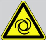
Diese Kennzeichnungen weisen auf rotierende Teile hin.
