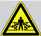
Diese Kennzeichnung weist auf eine mögliche Quetschgefahr hin.
