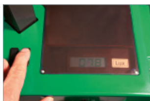
Nærlysets blændværdi samt fjernlysets belysningsstyrke findes hurtigt og præcist med det digitale luxmeter.
